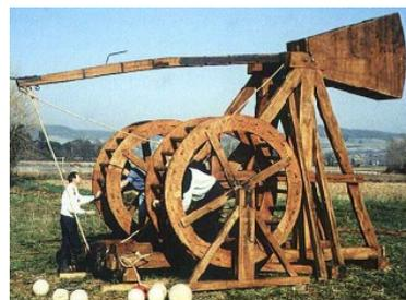
> **Le trébuchet\*** : machine à contrepoids articulé dotée d'une très grande précision de tir avec un même point d'impact possible. Son objectif est de marteler un endroit précis d'une muraille, par exemple un point faible du mur comme une meurtrière. Cadence de tir faible : 2 tirs/heure, portée : 220m, boulet : 140kg.
