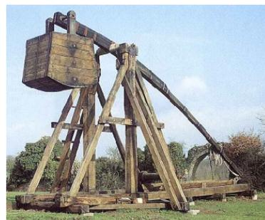
> **Le couillard\*** : machine perfectionnée à deux contrepoids articulés. Performances inférieures à celle du trébuchet mais d'une cadence de tir 5 à 6 fois supérieure avec une équipe plus réduite. C'est la machine à contrepoids la plus perfectionnée qui lui a permis longtemps de concurrencer l'artillerie à poudre. Ses deux huches articulées facilitent la manutention de l'engin en divisant par deux les charges à manier. Cadence de tir rapide : 10 tirs/heure, portée : 180m, boulet : 60kg.
